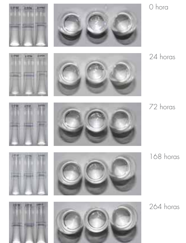
Figura 3: prueba de estabilidad UV (caja de luz). Fuente: Shell.
