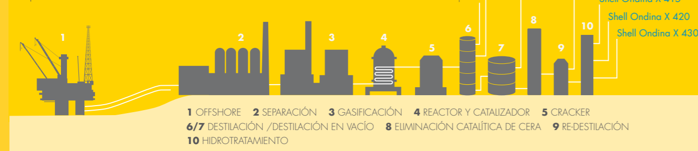
Figura 1: El proceso GTL convierte gas natural de combustión limpia en combustibles de quemado más limpio y aceites base de alta calidad por medio del proceso Fischer-Tropsch. Los aceites base GTL están además procesados para producir aceites blancos medicinales de alta calidad. Fuente: Shell.
